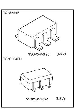
Weight SSOP5-P-0.95 : 0.016 g (typ.) SSOP5-P-0.65A : 0.006 g (typ.)
